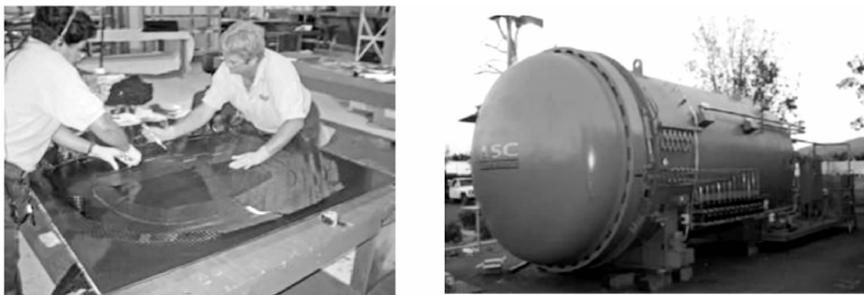
图 6 预浸料热压罐工艺
